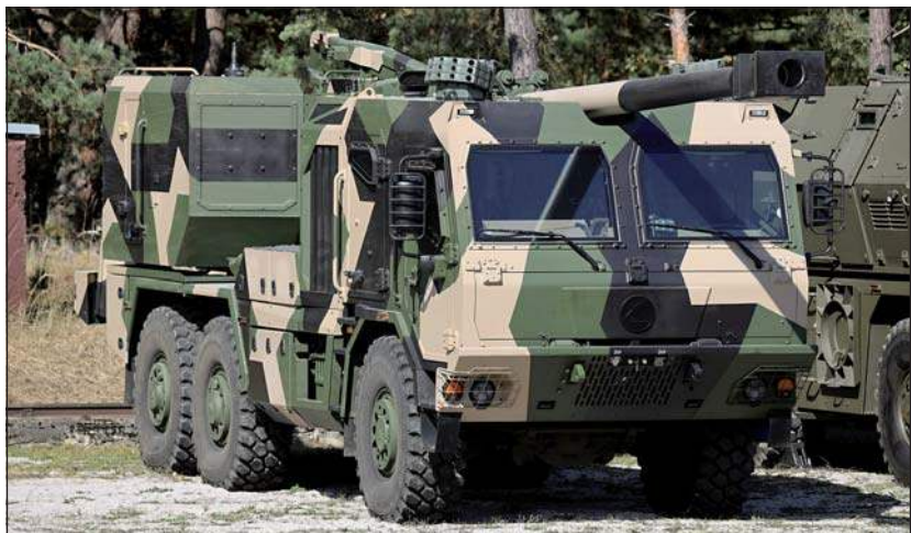
■ Pohľad spredu na samohybnú kanónovú húfnicu EVA M 6x6, na strope kabíny vidno žľab, kam sa ukladá hlavňa zbrane
